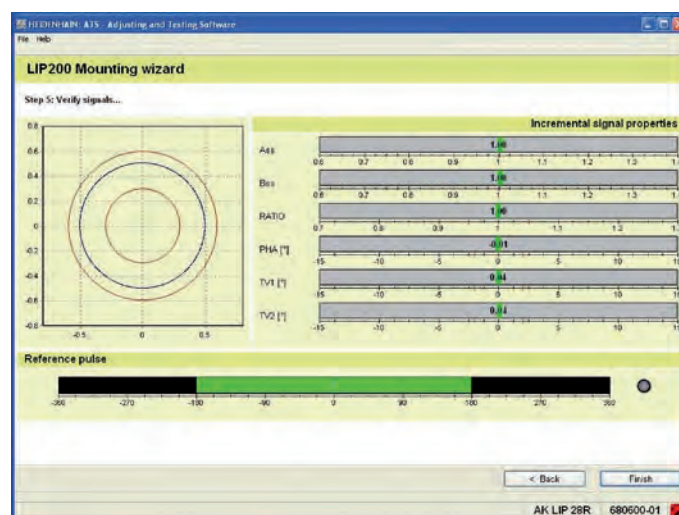
Mise en service avec le PWM 21 et le logiciel ATS
