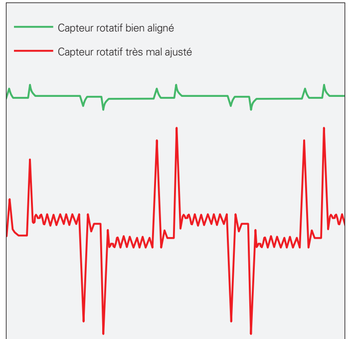
Courant du moteur avec un capteur rotatif qui a été bien réglé et un capteur rotatif très mal ajusté
