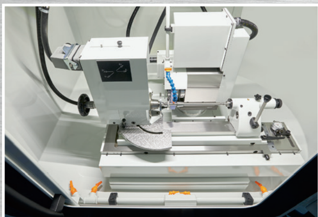
▲ Travail entre-pointe avec poupée standard W20
