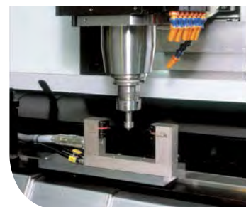
Taratura utensili laser Laser tools setting device
