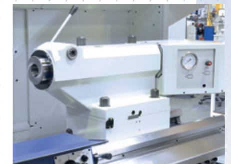
Fourreau de la poupée mobile à actionnement hydraulique
