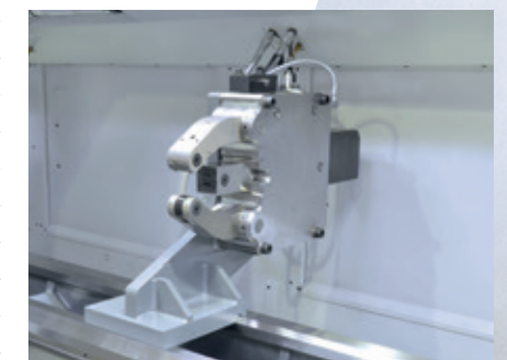
Lunette fixe, autocentrante, à actionnement hydraulique
