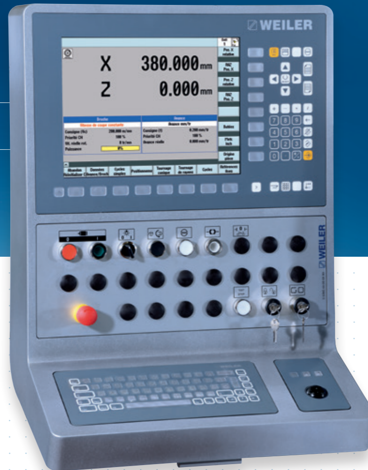
Surface utilisateur claire avec écran 15» et clavier à effleurement additionnel avec touches à faible course
