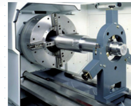
Mandrin à commande pneumatique et lunette fixe
