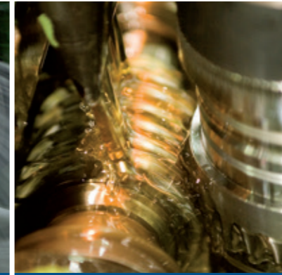
Fabrication de pignons / Fraisage par développante
