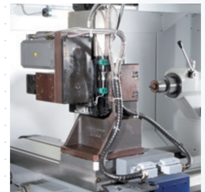
Axe Y avec une course de 200 mm
