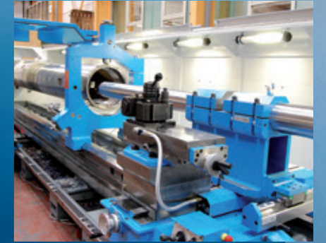
Porte-barre d'alésage renforcé avec appui additionnel et diamètre 160 mm
