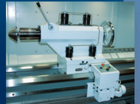
Poupée mobile avec blocage automatique sur banc et entraînement propre
