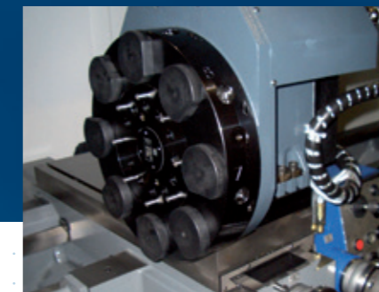
Tourelle revolver à 8 postes avec outils entraînés, diamètre de la queue 40 mm
