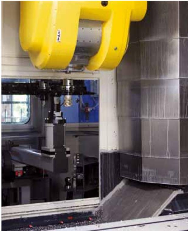
La machine Tarkus est équipée d'un magasin d'outils à chaîne avec une capacité de 32 à 64 postes; d'autres magasins sont disponibles avec une configuration statique jusqu'à 180 postes.
