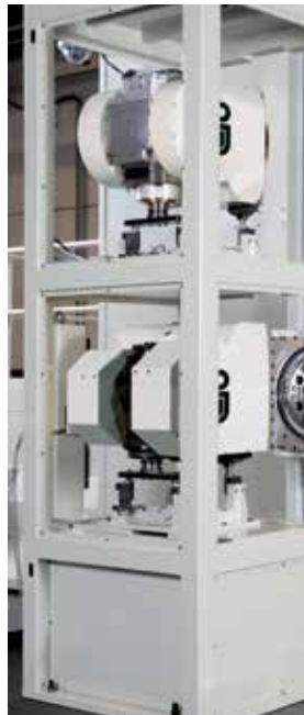
Possibilité de changement automatique de têtes de fraisage BUSS
