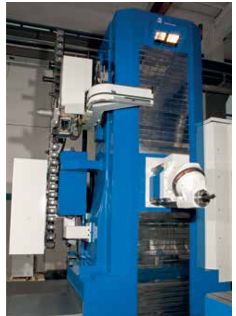
Magasin d'outils à chaîne 40/60 postes ISO 50/HSK-A-100
