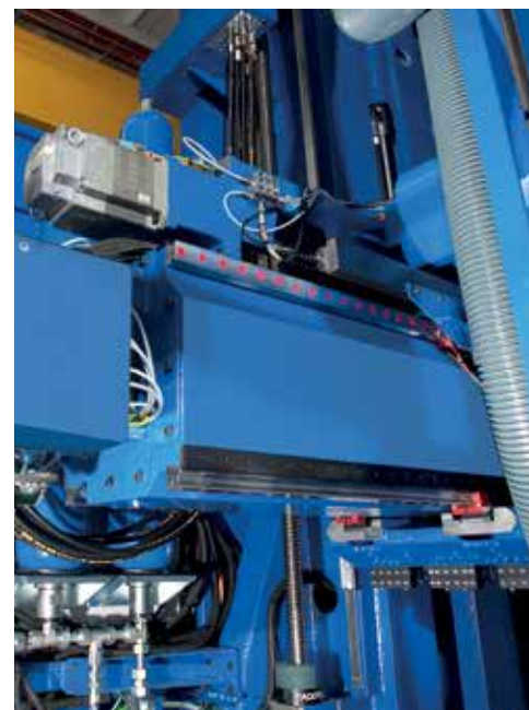
Structure du béliet symétrique, avec quatre glissières de guidage, l'arbre de broche et le moteur sont centrés
