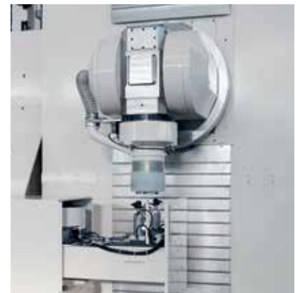
Groupe d'aspiration des poussières au niveau de la broche à haut rendement avec en option le changement automatique des coiffes et un magasin de coiffes
