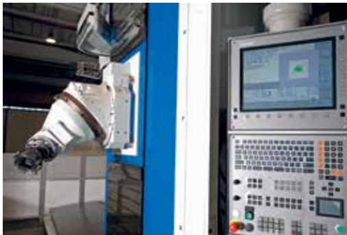
Système de programmation/MDI en axes polaires réels pour tête de fraisage indexée
