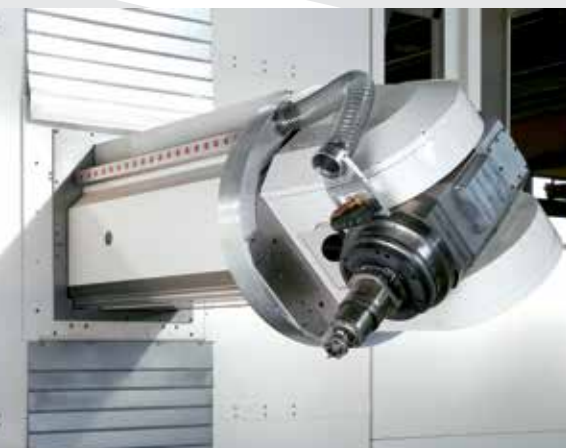
Tête twist de fraisage à haute performance (puissance 44 kW, 15000 tr/mn)
