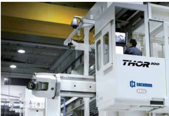
Meilleure vision des opérations d'usinage et une accessibilité directe à la pièce, si nécessaire, dans des conditions maximum de sécurité pour l'opérateur
