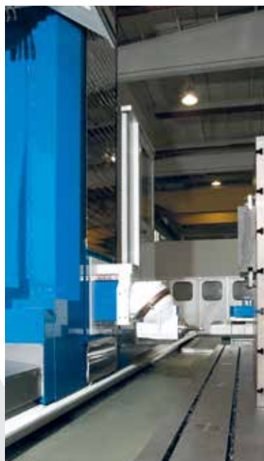
Structure optimisée pour garantir une distance minimum (738 mm) entre le nez de broche et le sol
