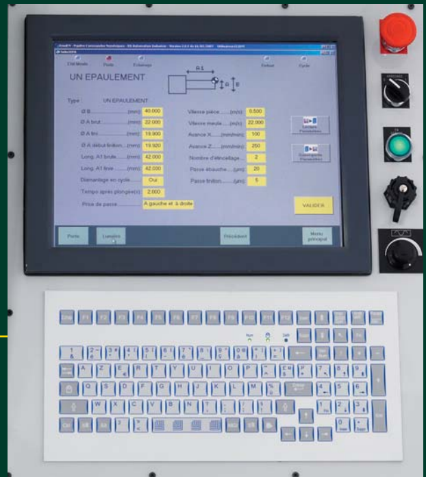
Interface opérateur avec exemple de paramétrage de cycle
