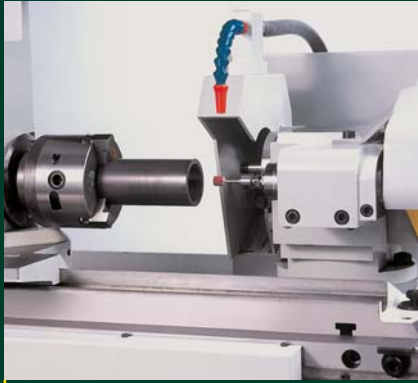
Broche de rectification intérieure mécanique
