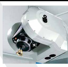
En alternative, Frazer peut être équipé de têtes continues à electrobroche avec différentes solutions de puissance et vitesse pour l'usinage d'alliages légers et la finition de moules à grande vitesse.
