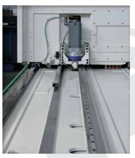
Structure à montant mobile avec course axe X (longitudinale) de 3 à 5 m («Box Version») et jusqu'à 30 m («Open Version»). L'axe X est équipé de guidages linéaires à recirculation de rouleaux multi-patins avec système à double moteur Dual Drive, pignons motorisé et crémaillères de précision.
