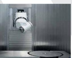
Possibilité d'installer une table tournante avec capacité de charge jusqu'à 3 ton et/ou une table de tournage actionnée par de moteurs torque.
